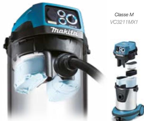
L'innovativo sistema di pulizia alternato dei filtri (modelli VC2211MX1, VC3211MX1 e VC3211HX1) permette di non ridurre la capacità di aspirazione. Durante la fase di pulizia le performance dell'aspiratore rimangono costanti grazie al sistema di gestione per singola unità filtrante. Mentre una unità è in fase di pulizia, l'altra prosegue la normale attività di filtraggio.
