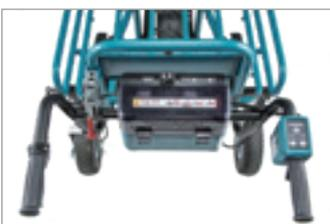
**Impugnatura, sistema comandi, selettore due velocità ed alloggiamento batterie:**
