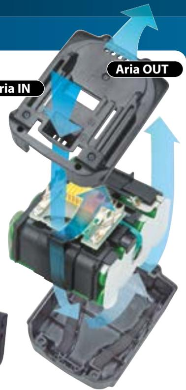
Prima di ricaricare la batteria è necessario raffreddarla perchè dopo l'uso la sua temperatura aumenta. Makita ha sviluppato uno specifico sistema di ricarica che prevede l'uso di una ventola di raffreddamento che in modo efficiente riduce i tempi di attesa per iniziare la ricarica che avviene solo a temperatura idonea. La ventola di raffreddamento è attiva anche durante la ricarica e velocizza il processo di carica.
