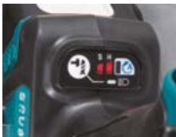
Pannello elettronico selettore funzioni per gestione avvio lento, illuminazione e selettore delle velocità.
