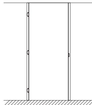
Telaio battente per un'anta senza traverso
