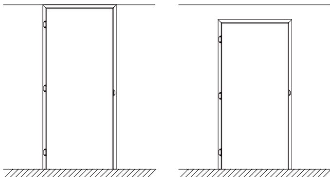
Telaio battente per un'anta con traverso
