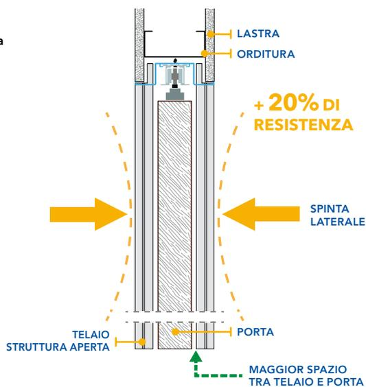
La struttura aperta è in grado di resistere alla flessione laterale, oltre il 20% in più rispetto alle strutture equivalenti oggi in commercio.\*
