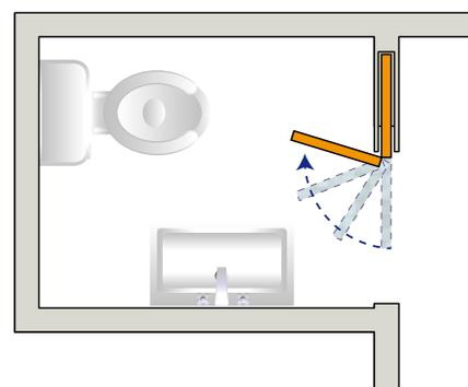
Il modello ECLISSE NOVANTA invece permette a mezza porta di scomparire dentro il muro e all'altra mezza di aprirsi a battente. Et voilà, problema risolto!
