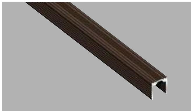
È un profilo in alluminio anodizzato applicabile nella fresata inferiore della persiana scorrevole; garantisce uno scorrimento fluido e silenzioso del serramento evitando possibili deformazioni o rigonfiamenti causati dall'assorbimento di umidità da parte del legno della persiana.
