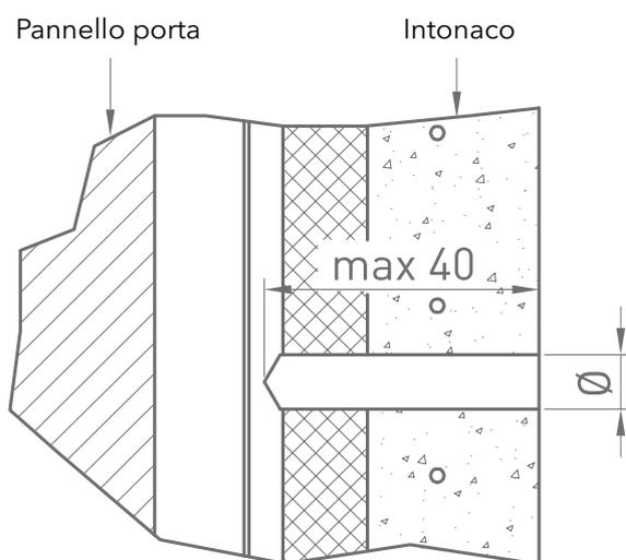
Diametro foro per ancoraggio con tasselli ad espansione = Ø 8 mm
