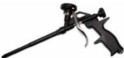
Pistola professionale per schiuma poliuretanicca con impugnatura ergonomica realizzata in lega leggera con tripla guarnizione di tenuta al teflon ed ugello da 4 mm. Grazie al regolatore micrometrico di portata, si riesce a dosare la giusta quantità di schiuma senza sprechi.
