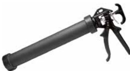
Pistola professionale per sacchetti in alluminio da 400-600 ml. Realizzata in lega leggera con tubo in alluminio ed impugnatura ergonomica. Grazie al suo meccanismo brevettato di compensazione di usura che consente di correggere automaticamente il gioco del pistone di avanzamento, si riesce ad avere una precisa azione d'impulso dal primo utilizzo fino all'ultimo. Questo meccanismo, inoltre, consente di estrarre dei cordoli di silicone in modo molto preciso evitando accumuli
