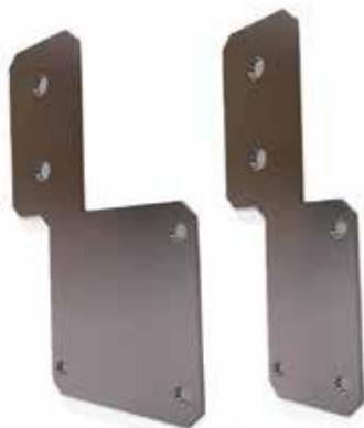
Staffe in acciaio per la congiunzione della traversa inferiore alla spalla. Sono realizzate con dei fori predisposti alla giusta distanza per inserire le viti nelle nervature del traverso. Si fissano con delle viti autofilettanti da PVC da 3,5x35 mm senza preforatura. Grazie alla sua particolare geometria può essere inserita con semplicità sia nelle nervature del controteelaio Klima Pro, sia fissata direttamente sulle spalle in legno Termoframe Comfort e Plus.
