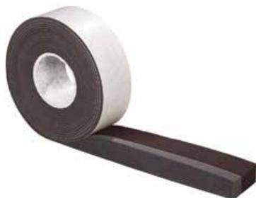
Nastro autoespandente multifunzionale con 1 pellicola di tenuta aria e vapore interna. Unisce i vantaggi dei nastri auto espandenti e delle pellicole di tenuta aria e vapore in un unico prodotto. Specificatamente studiato per la sigillatura della parte interna e mediana del giunto di collegamento della finestra al controltaio. Realizza giunti ad alta impermeabilità all'aria, al vapore e al rumore.
