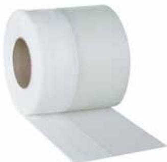
Pellicola di tenuta aria-vapore in tessuto sintetico bianco ad Sd variabile con rete porta intonaco integrata. Dispone di un nastro autoadesivo da incollare sul controtelaio e di una retina porta intonaco da 100 mm da risvoltare sul muro per l'intonacatura. La pellicola è soprintonacabile ed è caratterizzata da un valore di diffusione del vapore SD variabile, che ne consente l'utilizzo sia all'interno che all'esterno.
