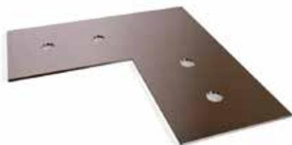
Piastra di allineamento 80x80 mm spessore 1 mm esterna per il controtelaio Klima Pro realizzata in acciaio zincato. Con questo accessorio si garantisce il perfetto allineamento della battuta nell'angolo, evitando possibili disassamenti. E' dotata di prefori per essere avvitata direttamente all'esterno della battuta del controtelaio, con viti 3,5x16mm.
