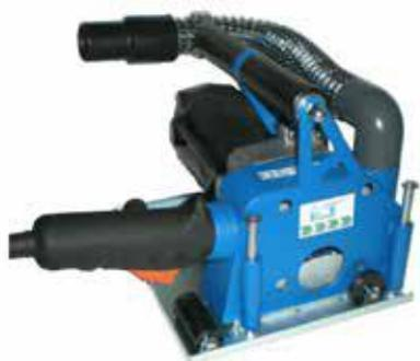
Speciale elettroutensile realizzato dal team di ricerca Posaclima, specificatamente studiato per il taglio del davanzale passante nella sostituzione dei serramenti. Dotato di doppio disco diamantato, realizza un taglio di mm 24 in meno di 3 minuti. Rispetto ai comuni scanalatori presenti sul mercato, lo scanalatore Renova presenta i seguenti vantaggi:
