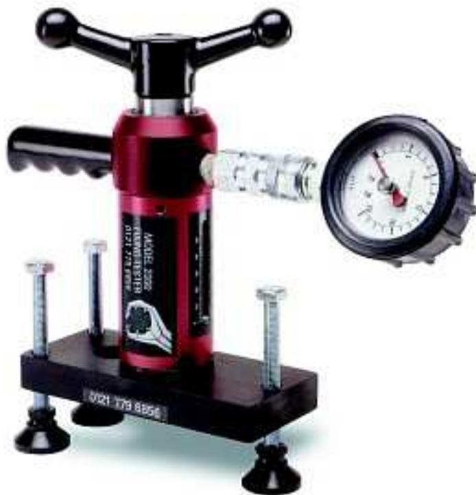
La nostra società Vi presenta un dispositivo di misura universale, per controllare la portata delle viti e dei tasselli negli ancoraggi delle ponteggiature.
